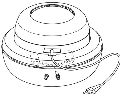
Le Condair 505 est également disponible en **version spéciale Condair 505 S**, pour le raccordement à la conduite d'eau. Le Condair est équipé d'un raccord d'eau avec soupape à flotteur ainsi que d'un trop plein.
