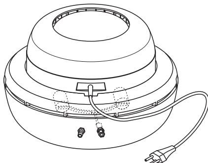
Con il nome **Condair 505 S esecuzione speciale**, viene indicato un apparecchio che si può direttamente collegare alla rete idrica. Il Condair 505 S è equipaggiato di un attacco per il collegamento idrico, una valvola galleggiante e un tubo di scarico per sovrappieno.
