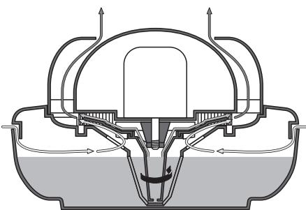
Il Condair 505 funziona secondo il principio di un nebulizzatore. L'acqua succhiata dalla bacinella tramite l'ugello d'aspirazione, viene centrifugata dal piatto della centrifuga contro la corona del nebulizzatore, causando l'effetto aerosol con relativa nebulizzazione.
