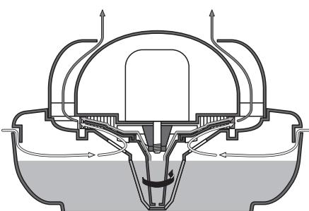
Der Condair 505 arbeitet nach dem Zerstäuberprinzip. Das Wasser wird über den Saugstutzen aus dem Wasserbecken angesaugt und über den Schleuderteller gegen den Zerstäuberkranz geschleudert. Dabei wird das Wasser in Aerosole (Nebel) verwandelt.
