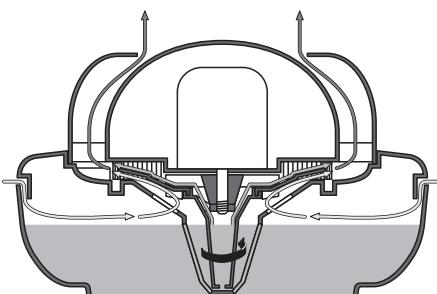
Le fonctionnement du Condair 505 est basé sur le principe de pulvérisation. L'eau, ayant traversé l'embout d'aspiration, est renvoyée sur le disque de projection et projetée contre l'anneau atomiseur. Cette opération transforme l'eau en aérosol (brouillard).
