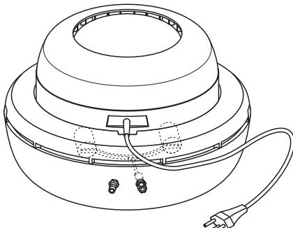
Der Condair 505 ist auch als **Spezialausführung Condair 505 S** für den Anschluss an das Wassernetz erhältlich. Der Condair 505 S besitzt einen Wasseranschluss mit einem Schwimmerventil und einen Anschluss für eine Überlaufleitung.
